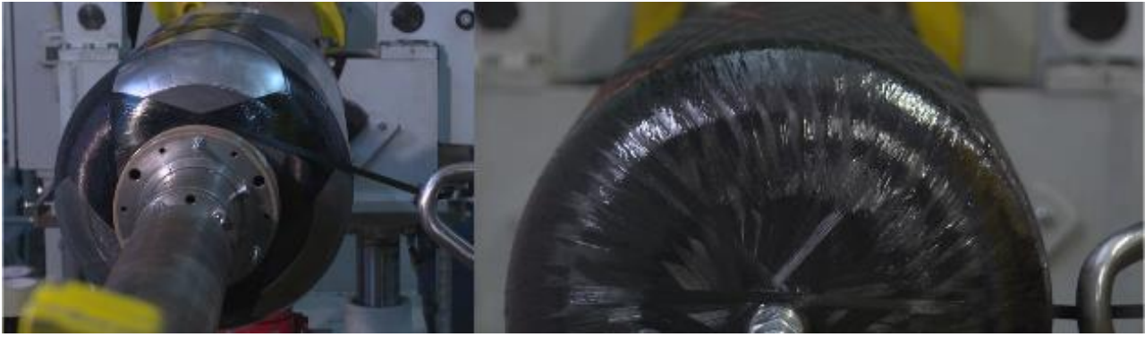
Рисунок 5 – Намотування несучої та силової оболонки дослідного зразка
