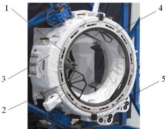
Рисунок 1 – Стыковочный агрегат международного стандарта 1 – крюк; 2 – направляющий лепесток; 3 – корпус; 4 – направляющий штырь; 5 – отверстие под направляющий штырь
