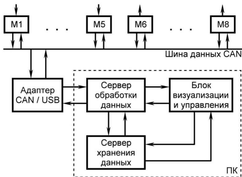
Рисунок 2 – Структурная схема лабораторной ИИС
