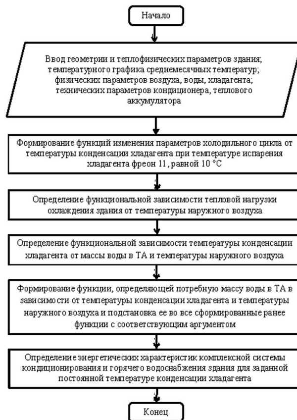
Рисунок 3 – Блок-схема технологии утилизации теплоты с изменяющимся объемом ТА
