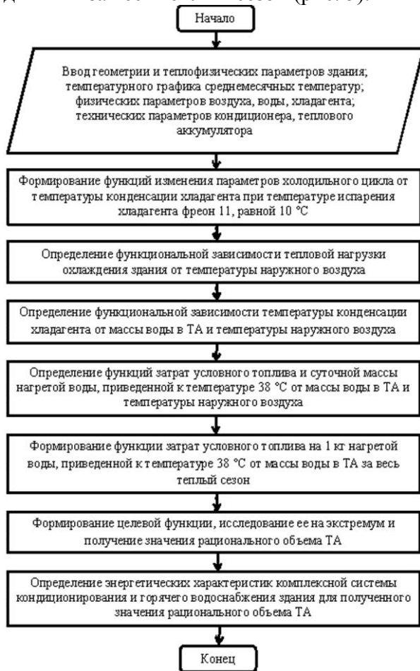
Рисунок 2 – Блок-схема технологии утилизации теплоты с постоянным объемом ТА
